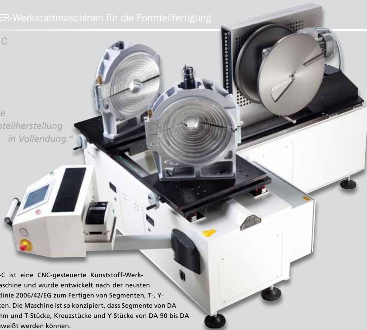
Die HWT 400-C ist eine CNC-gesteuerte Kunststoff-Werkstattsschweißmaschine und wurde entwickelt nach der neusten Maschinenrichtlinie 2006/42/EG zum Fertigen von Segmenten, T-, Y- und Kreuzstücken. Die Maschine ist so konzipiert, dass Segmente von DA 90 bis DA 400 mm und T-Stücke, Kreuzstücke und Y-Stücke von DA 90 bis DA 315 mm<sup>(1)</sup> geschweißt werden können.
