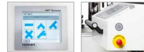
Die Maschine wird serienmäßig mit einem hochauflösenden Farb-Touchscreen der neuesten Generation geliefert. Über diese Einheit können sowohl alle erforderlichen Rohrparameter als auch die notwendigen Traceability-Daten eingegeben und angezeigt werden.
